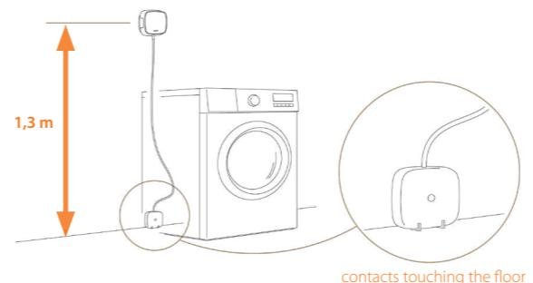
Den Kabelfühler mit Hilfe der Klebestreifen oder Schrauben anbringen, z.B. hinter der Wäschmaschine. Die Pins müssen nach vorne zeigen und den Boden berühren. Klebestreifen am Sensor anbringen, Sensor in 1,30 m Höhe montieren.
