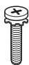
Βίδες βάσης 8 ΕΑ, M4 x L20 (Μόνο για τα μοντέλα UB83**-ZB) (Ανατρέξτε στη σελίδα A-4) 4 ΕΑ, M4 x L20 (Μόνο για τα μοντέλα UB80**, UB82**, UF695*-ZB) (Ανατρέξτε στη σελίδα A-3)
