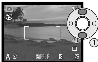
Usate i tasti alto/basso del "joystick" (1) per impostare l'apertura di diaframma. Il valore di apertura si modifica con incrementi di 1/3 stop. Premete parzialmente il pulsante di scatto per attivare il sistema esposimetrico: sullo schermo LCD compare il tempo di scatto più adatto.
