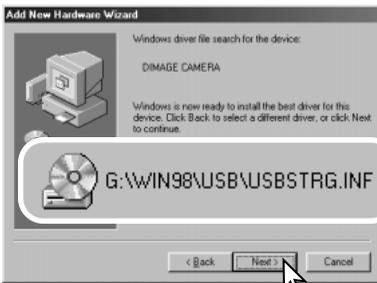
Confermate la posizione del driver nella finestra di aggiunta di un nuovo hardware. La lettera identificativa del drive per CD-ROM può variare a seconda del tipo di computer in uso. Fate un click su "Next" (Successivo) per installare il driver nel sistema operativo.
