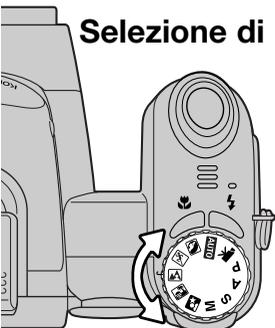
Con il Programma soggetto digitale vengono ottimizzate le impostazioni della fotocamera, come il bilanciamento del bianco o il sistema di elaborazione immagine, in base a specifici soggetti e condizioni di ripresa. Ruotate il selettore del tipo di esposizione per scegliere il Programma soggetto più adatto, il Programma attivo viene segnalato nell'angolo in basso a sinistra dello schermo.
