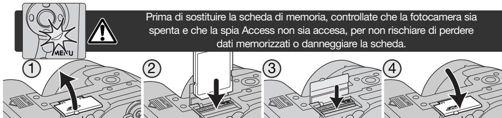
1. Aprite il coperchio dello slot di alloggiamento della scheda alla base della fotocamera.
