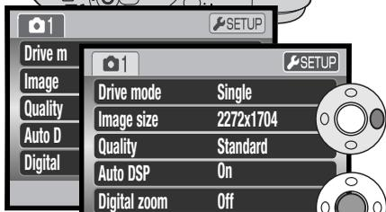
Con il tasto destro del "joystick" evidenziate l'impostazione setup sulla linea superiore del menu.
