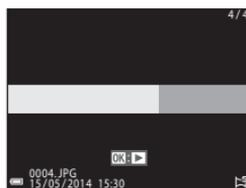
Während der Wiedergabe werden die Steuerelemente für die Wiedergabe unten am Monitor eingeblendet. Drücken Sie **◀** am Multifunktionswähler, um ein Steuerelement auszuwählen, und dann die **OK**-Taste, um die folgenden Operationen auszuführen.
