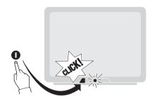
Netzschalter drücken. Die rote Kontrolleuchte leuchtet. Das Gerät ist jetzt in Bereitschaft.
