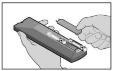
Mitgelieferte Batterien einsetzen. Polarität beachten! Die Fernbedienung wird nur dann funktionieren, wenn die Batterien korrekt eingesetzt sind (siehe Zeichnung).
