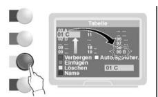
3 - Gelbe Taste drücken. Der gelöschte Sender wird automatisch auf Platz 99 verschoben. Alle anderen Sender rücken um einen Platz vor. Sie können auch mehrere Sender löschen. Wiederholen Sie dazu die Schritte 2 und 3. Die gelöschten Sender werden automatisch auf die Plätze 98. 97. 96 usw. verschoben.
