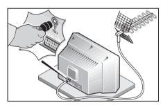
Antennenstecker in die Antennenbuchse auf der Geräterückseite stecken.
