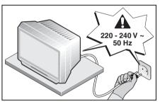
Nur an eine haushaltsübliche Steckdose von 230V / 50Hz anschließen. Der Betrieb an Wechselrichtern oder Notstromaggregaten kann das Gerät beschädigen. Der Hersteller übernimmt keine Gewähr für den Betrieb an solchen Einrichtungen.
