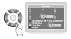
2 - Mit den 4 abgebildeten Tasten den zu löschenden Programmplatz auswählen.
