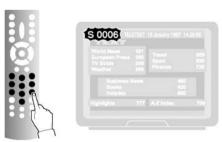
2 - Um die Unterseite 6 anzuzeigen, geben Sie ein: 0006. Sobald die Unterseite 6 gesendet wird, wird sie angezeigt. Die übrigen Unterseiten werden nicht automatisch angezeigt.
