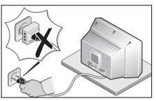
Netzstecker nur an unbeschädigte fehlerfreie Steckdosen anschließen. Verwenden Sie keine Doppel- oder Dreifachsteckdosen. Diese Steckdosen gewährleisten nicht unter allen Umständen einen sicheren Kontakt.
