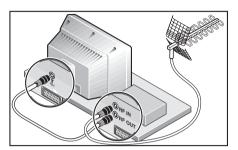
Schließen Sie die Antenne an den Videorecorder an. Verbinden Sie den Antennenausgang des Videorecorders mit der Antennenbuchse des Fernsehgerätes. Benutzen Sie dazu das mit dem Videorecorder mitgelieferte Koaxialkabel.
