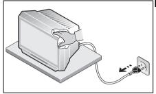
Zur Reinigung den Netzstecker ziehen! Mit einem angefeuchteten weichen Lappen abwischen.
