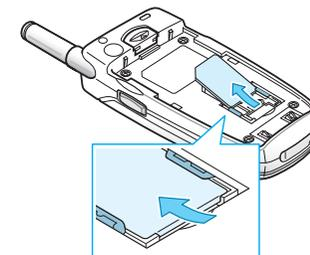
4. Posizionare la batteria in modo che le linguette all'estremità si allineino con gli alloggiamenti nella parte inferiore del telefono.
