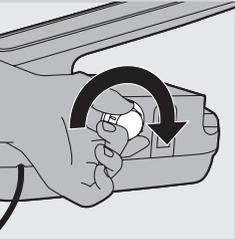
**9** Riavvitate a fondo il tappo del sistema Calc-Clean sul generatore di vapore.
