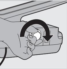
**9** Vissez fermement le bouchon Calc-Clean sur la chaudière.
