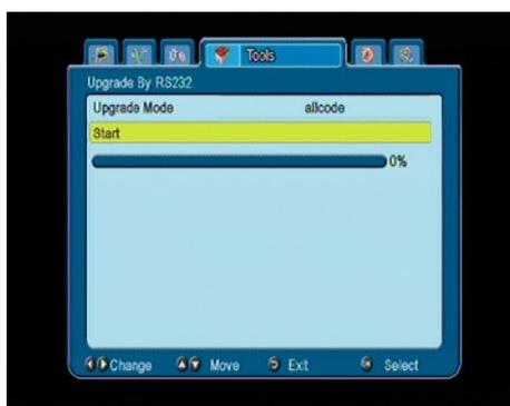
Ce menu vous permet de mettre à jour le logiciel, les paramètres et la listes des chaîne d'un récepteur à un autre récepteur du même type. Connecter les deux récepteurs en utilisant un câble inversé RS232. Choisissez **allcode** transférer tout le logiciel ou **userdb** pour transférer uniquement la liste des chaînes.
