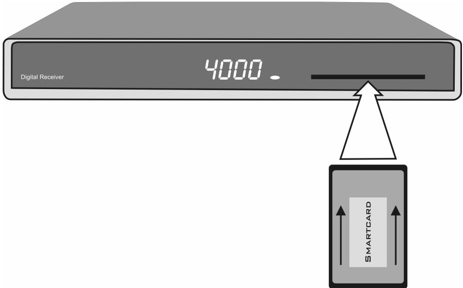
Nachdem die Smart Card eingesetzt wurde, kann das entsprechende Programm angewählt werden. Es kann einige Sekunden dauern, bis das Programm freigeschaltet wird.
