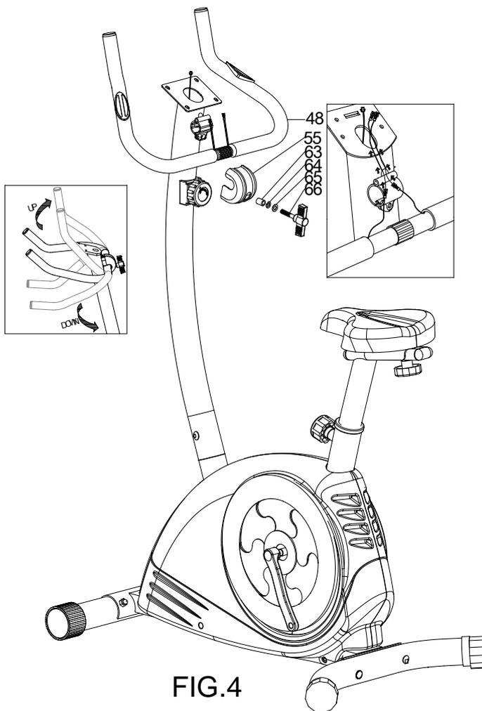
1. Puls kabel durch das Rohr führen, anschliessend Lenker (48) an Lenkersäule (5) befestigen mittels Schutzabdeckung (55), Buchse (63), Federscheibe (64) sowie Unterlegscheibe (65) und mittels Flügelschraube (66) fixieren. Der Lenker ist
