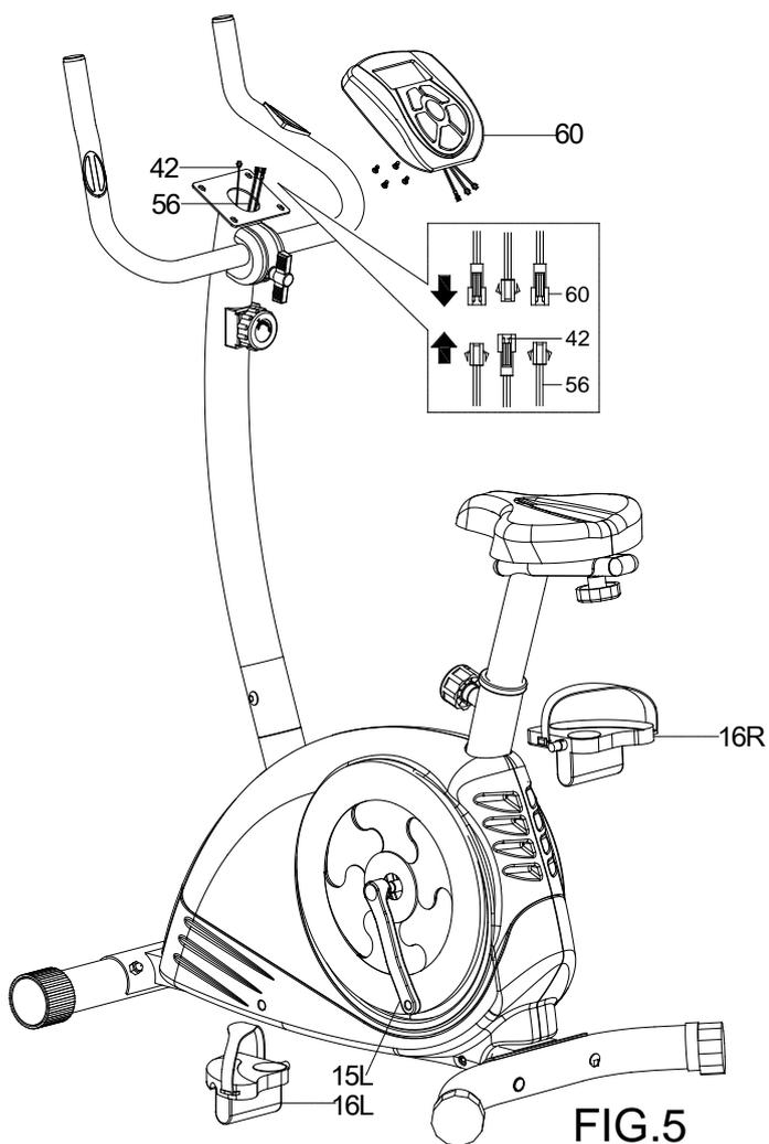
1. Unteres Computerkabel (42) und Kabel für Pulssensor (56) am Computer (60) anschliessen. Pedalriemen an Pedalen anbringen, anschliessend Pedale (16L&16R) am linken und rechten Tretkurbelarm (15L&15R) befestigen.
