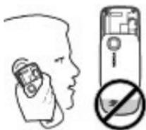
Il dispositivo potrebbe essere dotato antenne interne ed esterne. Evitare di toccare l'antenna mentre questa sta trasmettendo o ricevendo, se non è strettamente necessario. Il contatto con le antenne ha impatto sulla qualità delle comunicazioni radio e può comportare un maggiore consumo energetico durante l'utilizzo del dispositivo nonché una riduzione della durata della batteria.
