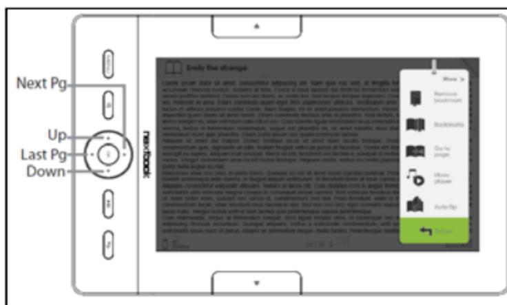
Im Querformat ist das Optionsmenü auf 2 Seiten verteilt. Zum Zugriff auf die Optionen der zweiten Seite gehen Sie mit dem Cursor auf [Mehr>] oben rechts im Optionsmenü.
