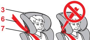
☞ Introduza o cinto diagonal **6** pelo suporte do cinto azul escuro **7** do apoio para a cabeça **3**, até ele escorregar para trás do dispositivo de fixação de segurança **7**.
