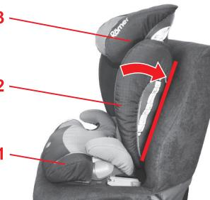
☞ Stellen Sie den Kindersitz auf den Fahrzeugsitz. Achten Sie darauf, dass die Rückenlehne **2** flächig an der Rückenlehne des Fahrzeugsitzes anliegt (siehe 3.2). **Tipp!** Wenn die Kopfstütze des Fahrzeugsitzes dabei stört, drehen Sie sie einfach um.
