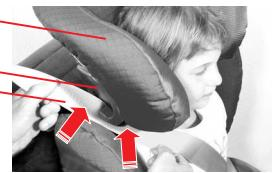
☞ Pase el cinturón diagonal **6** por el soporte de color rojo oscuro **7** del reposacabezas **3**, hasta que esté por completo en el soporte del cinturón **7** sin retorcerse.
