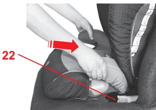
❖ Вставьте оба консольных фиксатора KIDFIX 15 в приемные приспособления 16 так, чтобы фиксаторы KIDFIX зафиксировались 15 с **обеих** сторон. "ЩЕЛК!"
