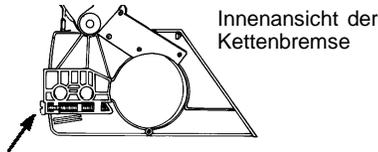
Justierschraube für Kettenspannung
