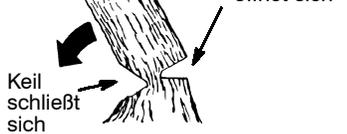
**HINWEIS:** Bevor Sie den Fallschnitt abschließen, weiten Sie den Schnitt falls notwendig mit Hilfe von Keilen, um die Fallrichtung zu kontrollieren. Verwenden Sie ausschließlich Holz- oder Plastikkeile. Stahl- oder Eisenkeile können Rückschlag und Schäden am Gerät verursachen.
