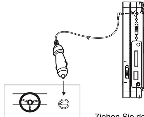
Ziehen Sie den Kfz-Adapter ab und schalten Sie das Gerät aus, bevor Sie die anderen Kabel anschließen.
