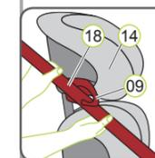
6. Führen Sie den Diagonalgurt (18) in den dunkelroten Gurthalter (09) der Kopfstütze (14) ein, bis er vollständig und unverdreht im Gurthalter (09) liegt.
