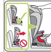
12. Ziehen Sie den Auto-Kindersitz ruckartig nach vorne, um sicherzustellen, dass er sicher befestigt ist und kontrollieren Sie erneut die ISOFIT-Rastarme (07), um sicherzustellen, dass beide vollständig eingerastet sind.
