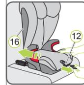
11. Ziehen Sie am Verstellgurt (12) und schieben Sie gleichzeitig den Kindersitz nach hinten, bis die Rückenlehne (16) flächig an der Rückenlehne des Fahrzeugsitzes anliegt.
