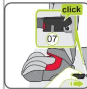
7. Schieben Sie den ISOFIT-Rastarm (07) in die Einführhilfe (02) bis der ISOFIT-Rastarm (07) mit einem „Klick“ Geräusch einrastet.
