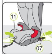
8. Halten Sie die ISOFIT-Einstelltaste (11) gedrückt und ziehen Sie den zur Fahrzeugsitz näheren ISOFIT-Rastarm (07) vollständig heraus.
