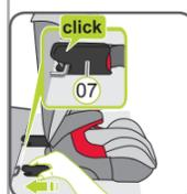
10. Schieben Sie den ISOFIT-Rastarm (07) in die Einführhilfe (02) bis der ISOFIT-Rastarm (07) mit einem „Klick“ Geräusch einrastet.
