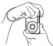
Halten Sie die Kamera so, dass der Blitz über dem Objektiv liegt.
