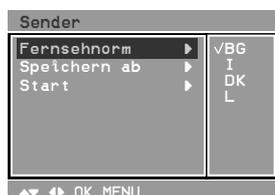
4. Betätigen Sie die Taste ►. Wählen Sie mit der Taste ▲ / ▼ die gewünschte Norm aus dem **Fernsehnorm**:
