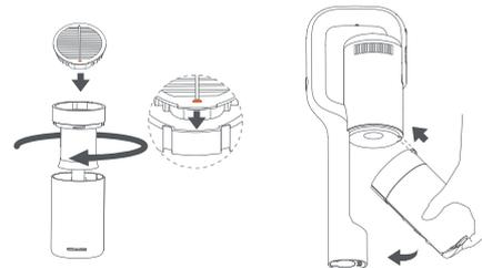
→ Il est recommandé de remplacer le filtre tous les 3 mois pour maintenir la plus haute efficacité. Utilisez uniquement les filtres spécifiés par le fabricant.
