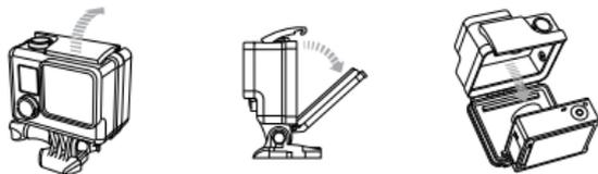
2. Retirez la porte latérale de la caméra et insérez une carte microSD, microSDHC ou microSDXC (vendues séparément) dans la fente des cartes. Il est nécessaire d'utiliser une carte microSD de classe 10 ou UHS-1.
