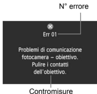
Se si verifica un problema con la fotocamera, viene visualizzato un messaggio di errore. Seguire le istruzioni visualizzate sullo schermo.
