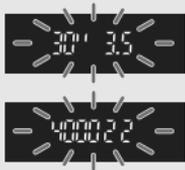
In condizioni di scarsa illuminazione o di illuminazione molto intensa, il display relativo alla velocità dell'otturatore e all'apertura lampeggia quando si preme a metà il pulsante di scatto, come illustrato nella figura. In condizioni di scarsa illuminazione (30" 3,5), aumentare la sensibilità ISO (p. 62) o utilizzare il flash (p. 64). In condizioni di eccessiva luminosità (4000 22), diminuire la sensibilità ISO.
