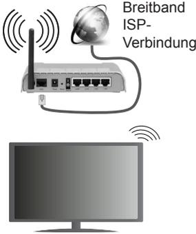
Ein WLAN-N-Router (IEEE 802.11a/b/g/n) mit den simultanen Frequenzbändern von 2,4 und 5 GHz ist darauf ausgelegt, eine größtmögliche Bandbreite zu ermöglichen. Optimiert für zügiges und schnelleres HD-Video-Streaming, schnellere Dateiübertragung sowie Online-Spiele (Wireless-Gaming).
