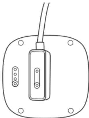
2. À l'aide d'un câble USB, connectez la base à un ordinateur ou à un adaptateur secteur USB pour commencer la mise en charge.
