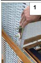
1 Scorrere prima la guida di metallo (E) sulle guide di plastica già montate sul pannello laterale della cesta superiore. Quindi scorrere la piastrina di collegamento su entrambi i bulloni e un disco di plastica sul bullone inferiore.
