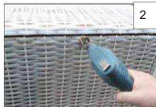
2 Per il fissaggio della staffa di supporto, è necessario montare alla parte posteriore della cesta superiore prima i profili a U (H) con 2 viti (C) nei punti segnati.
