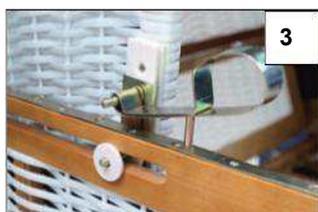
3 Quindi inserire la manopola di regolazione sul bullone superiore e un disco di plastica sul bullone inferiore.
