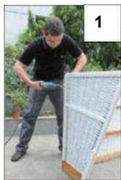
1 Per assemblare la cesta superiore, avvitare prima saldamente i pannelli laterali (7) con 4 viti (A) alle due componenti del pannello posteriore (8). La componente più piccola in questo caso è montata in basso, le cerniere sono rivolte verso terra. Per quanto riguarda la componente più grande, le chiusure in velcro sono rivolte verso l'alto.
