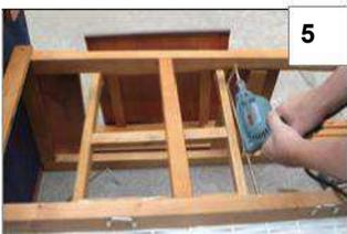
5 Nella parte anteriore della cesta inferiore ogni guida di scorrimento si avvita per mezzo di una vite (C) al listello.
