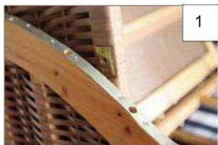
1 Prima mantenere la cesta superiore su quella inferiore, in modo che la piastra a vite pre-montata sulla cesta superiore si trovi in mezzo ai due fori sulla guida della cesta inferiore.
