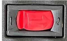
Lorsqu'il est réglé sur « **Souple** » : l'indicateur du curseur est au niveau de la vague et la flèche en direction de la ligne droite.
