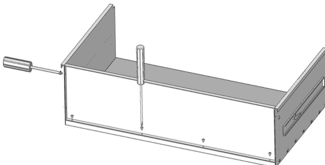
Rückwand so einsetzen, dass die Löcher auf die Gewindebohrungen passen.
