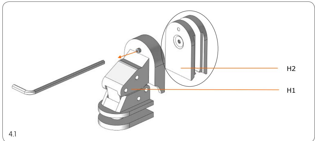
4.1 Lösen Sie die Fixierschraube mit dem mitgelieferten Inbus-Schlüssel, fahren Sie das Scharnier aus.
