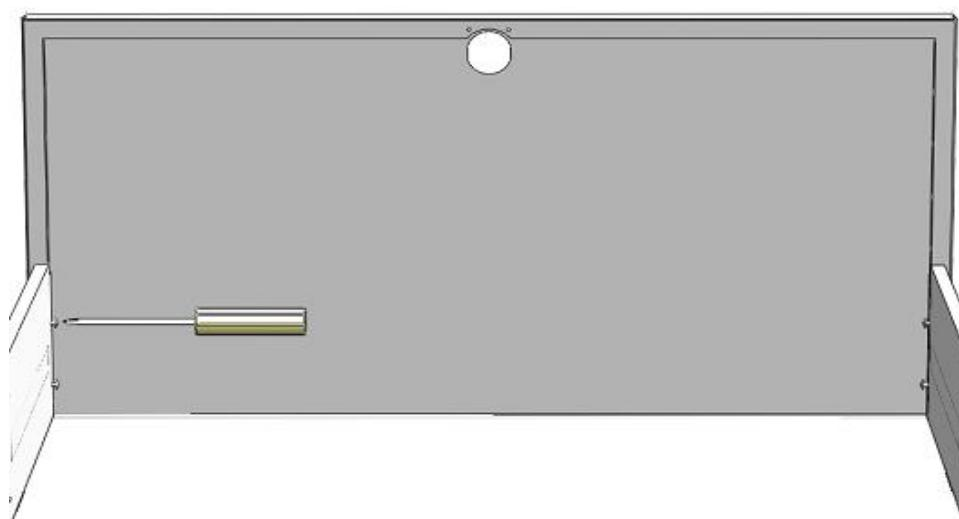
Seitenwände mit der Frontplatte von innen anschrauben - **aber die Schrauben noch nicht fest anziehen!**
