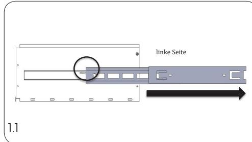
1.1 Die Schiene ganz ausziehen, Kunststoff-Lasche ganz nach **unten** drücken, Schiene herausziehen.
