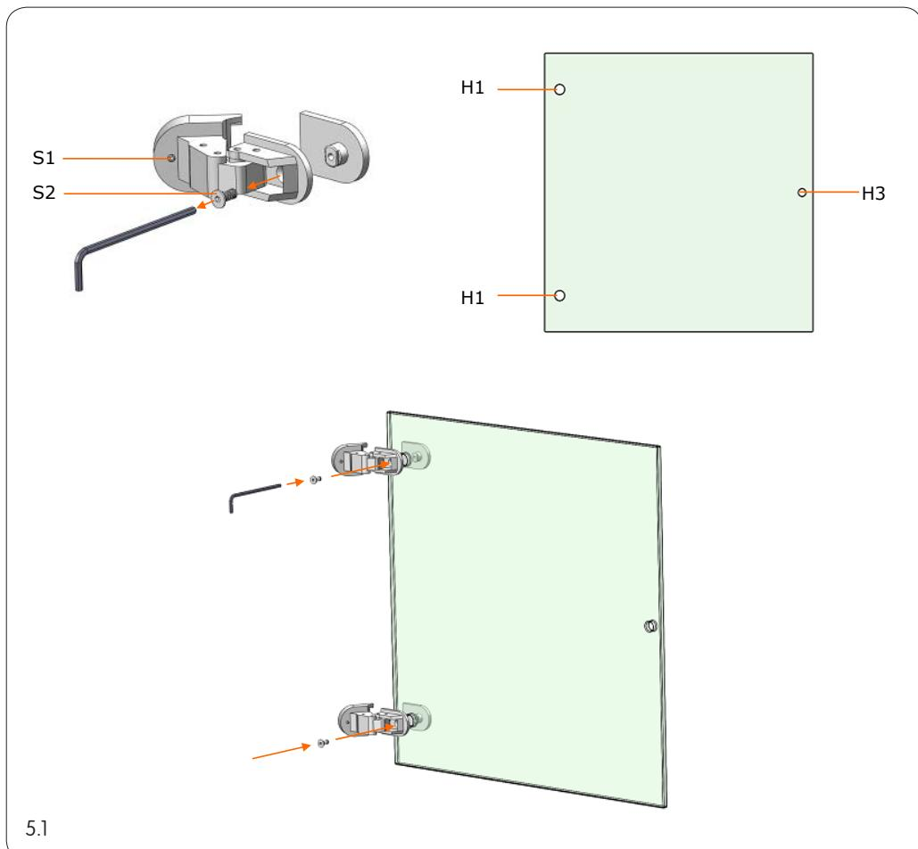
5.1 Lösen Sie die Fixierschraube S2 und befestigen Sie beide Scharniere mit den Klemmstücken an den Punkten H1 an der Glastüre. Achten Sie darauf, dass der rote Pfeil auf der Glastüre nach oben zeigt.
