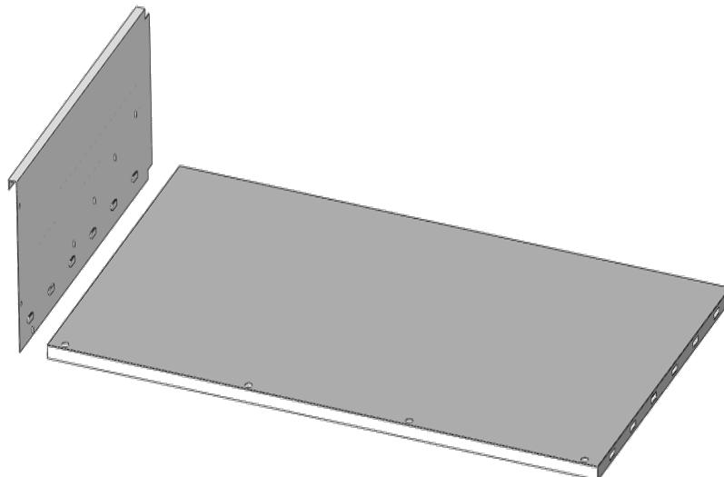
Bodenplatte mit den gebogenen Kanten nach unten hinlegen.
