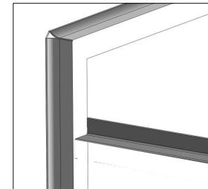
2.1 Die lange waagrechte Schiene zwischen Frontpanel und senkrechtem, hinteren Winkel anbringen. Die Schraube am Frontpanel nur wenig anziehen!
