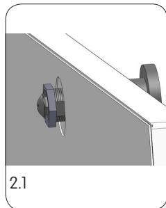
2.1 Zylinder von vorne durch den Griff schieben und mit der Mutter fest anziehen.
