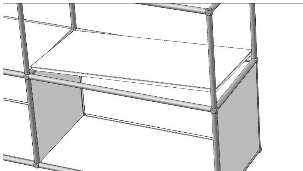
Bringen Sie erst die Bodenpanels und die äusseren Seitenpanels an. Alle weiteren erst, wenn die Fächer und Schubladen eingebaut sind.
