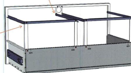
2.2 Befestigen Sie die langen waagrechten Schienen an den hinteren Winkeln.
