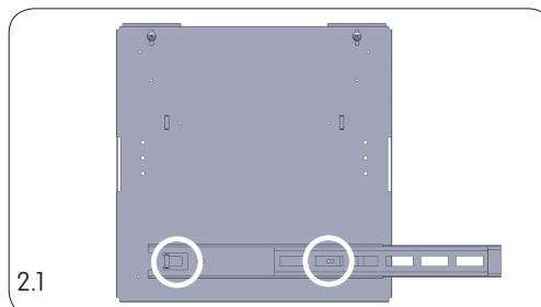
2.1 Die Schienen unter die Laschen einschieben und mit zwei Schrauben fixieren.
