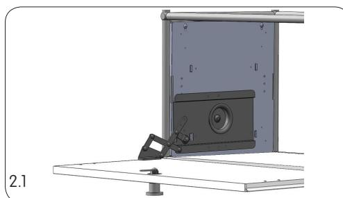
2.1 Klappe an das Fach halten und von hinten mit je 2 Schrauben die Winkel des Klapparms verschrauben.
