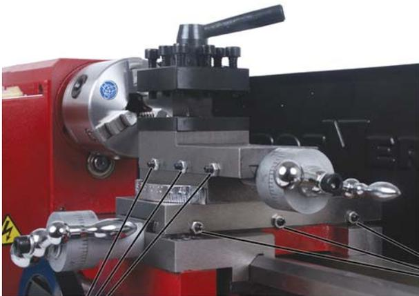
*Justageschrauben und Kontermuttern zum Justieren des Planschlittens*
