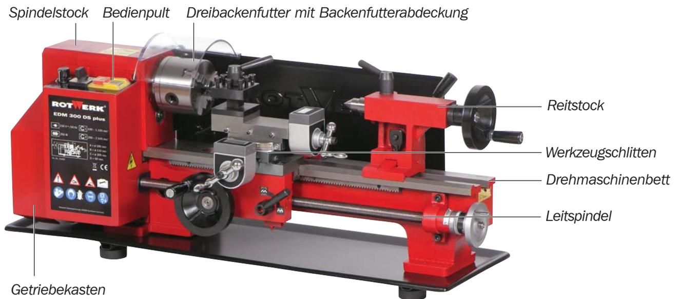
Die Hauptkomponenten der Drehmaschine bestehen aus Spindelstock, Bedienpult, Drehmaschinenfutter (Dreibackenfutter), Reitstock, Drehmaschinenbett, Werkzeugschlitten mit Schlosskasten, Leitspindel, Getriebekasten und dem Antriebsmotor.
