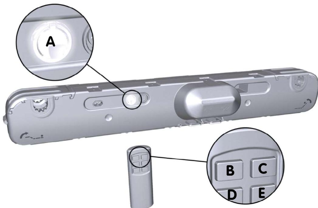
Um den Motor mit der Funkfernbedienung zu verbinden (pairen), drücken Sie **2x** die **Pairing-Taste (A)** am Empfänger bis die **Pairing-LED** aufleuchtet. Der Pairing-Prozess ist für die nächsten 10 Sekunden aktiv.
