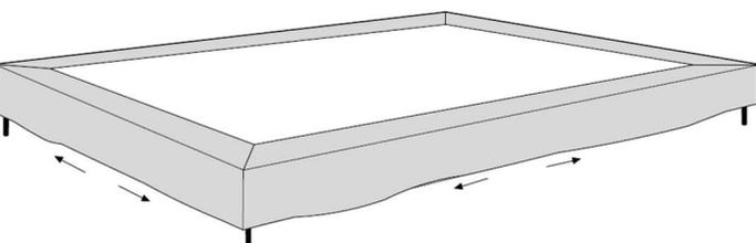
**a** Nach erfolgter Fussmontage die beiden Boxen zusammenschieben und mit dem Verbinder fixieren.
