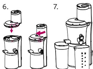
6. Verschlussdeckel / Einfülltrichter auf den Krug aufsetzen. Darauf achten, dass das offene Schlosssymbol des Deckels auf das Dreieck des Krugs gerichtet ist. Dann Verschlussdeckel im Uhrzeigersinn zudrehen, bis der Deckel hörbar einrastet.
