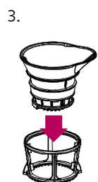
3. Sieb bis zum Anschlag in den Drehkäfig einsetzen (beim Einschieben ist ein leichter Widerstand von den Gummischabern zu spüren).
