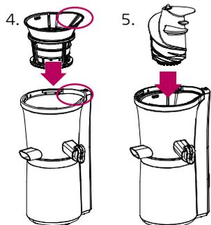
4. Setzen Sie nun das Sieb mit dem Drehkäfig so in den Krug ein, dass die seitlichen Einfüllöffnungen übereinander liegen (siehe Kreise).
