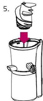
5. Schnecke bis zum unteren Anschlag in den Krug setzen. Beim Einschieben ist ein leichter Widerstand von der Gummidichtung zu spüren. Die Schnecke ist dann richtig eingesetzt, wenn sie sich nicht mehr drehen lässt.
