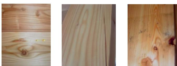
Durch die Kammetrocknung des Holzes kann es vorkommen, dass vor allem „Kantenäste“ bei der Hobelung ausbrechen. Drehen Sie in solchen Fällen die Dielen einfach um, sodass die ausgebrochenen Äste auf der Innenseite sind.
