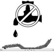
Bei Bedarf kann der Lattenrost mit einem trockenen Tuch gereinigt werden. Die Antriebskomponenten und die Elektrik sind grundsätzlich vor Nässe zu schützen!
