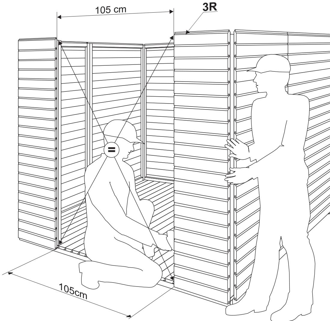
12. step: Apex for side wall • Giebel für die Seitenwand • Croupe sur le mur latéral • Pignone della parete laterale
