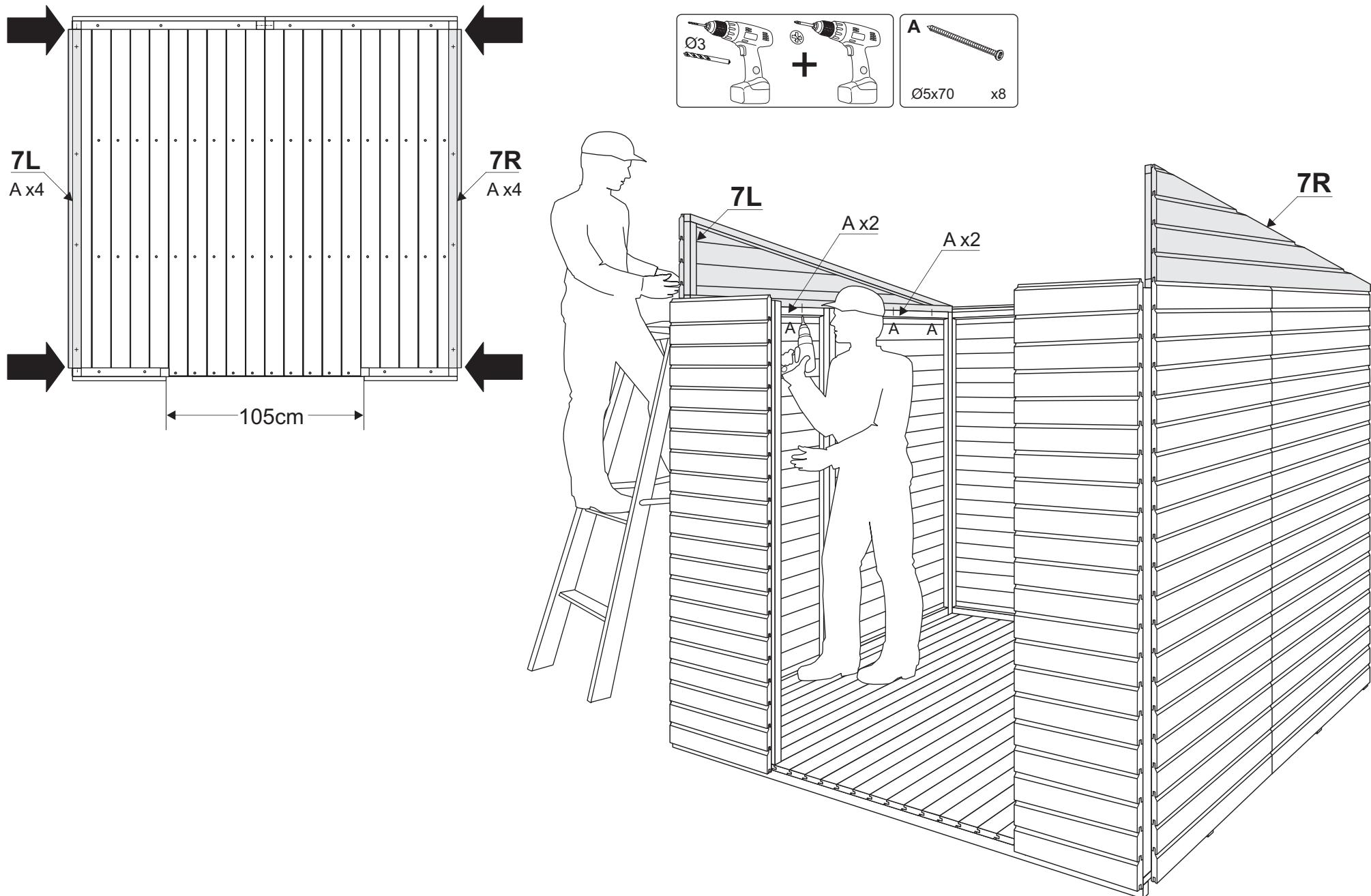
13. step: Apex for front wall • Giebel für die Vorderwand • Croupe sur le mur d'avant • Pignone della parete anteriore
