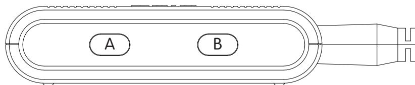
2. Drücken Sie am OKIMAT 2x die Verbindungstaste (B), bis die LED leuchtet. Sie haben nun 60 Sekunden Zeit zum Verbinden.
