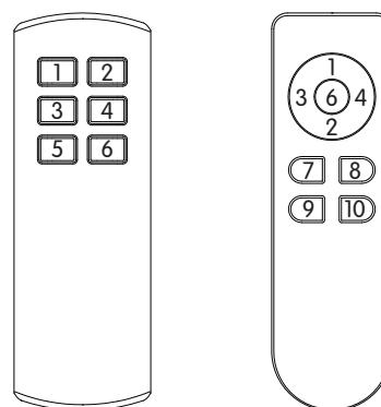
3. Drücken Sie gleichzeitig die Tasten (1) und (2) auf der Fernbedienung, bis die LED zu blinken beginnt. Wenn die LED des Empfängers blinkt, ist die Verbindung hergestellt. Hinweis: Der Abstand zwischen Empfänger und Fernbedienung sollte während des Verbindungsorgangs nicht mehr als zwei Meter betragen.
