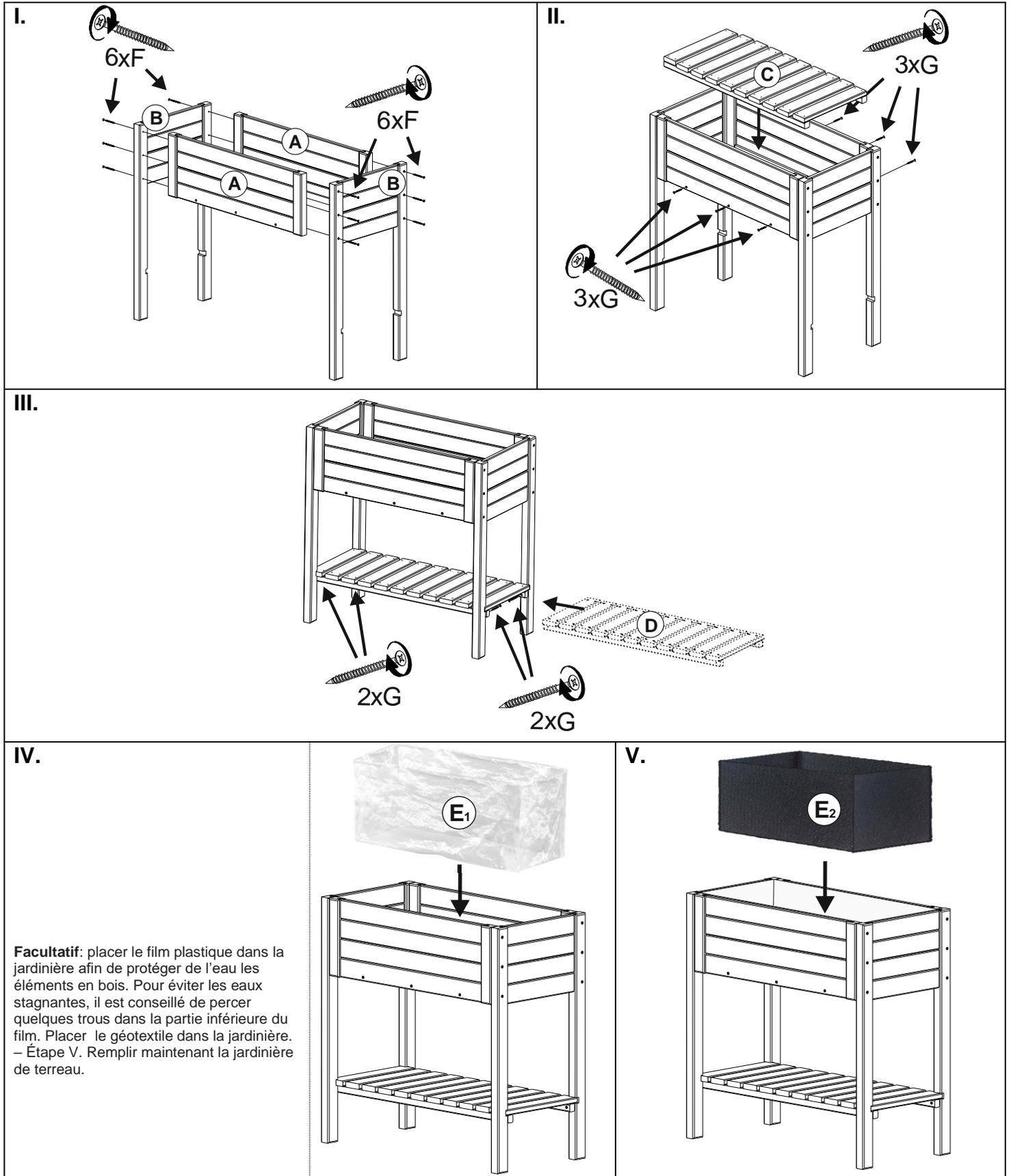
**Facultatif:** placer le film plastique dans la jardinière afin de protéger de l'eau les éléments en bois. Pour éviter les eaux stagnantes, il est conseillé de percer quelques trous dans la partie inférieure du film. Placer le géotextile dans la jardinière. – Étape V. Remplir maintenant la jardinière de terreau.
